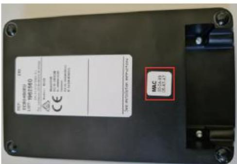
Der NCoder unterstützt DHCP. Für den DHCP Betrieb muss nur die MAC-Adresse eingetragen werden.
