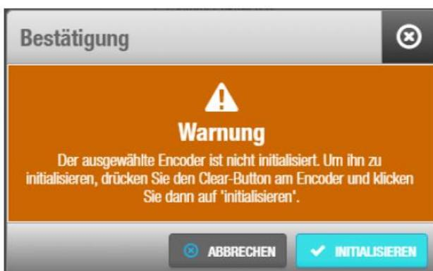
Zuerst erneut die CLR Taste 1x betätigen (NCoder blinkt rot) und anschließend auf Initialisieren klicken. Der NCoder sollte grün aufleuchten und funktionsfähig sein.
